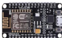
Gambar 2.3. NodeMCU ESP8266
