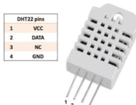
Gambar 2.1. Sensor DHT22
