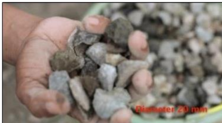
Gambar 5. Diameter Kerikil Yang Baik Untuk Campuran Beton
