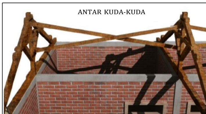
Gambar 34. Ikatan Angin Sebagai Pengikat Antar Kuda-Kuda Kayu
