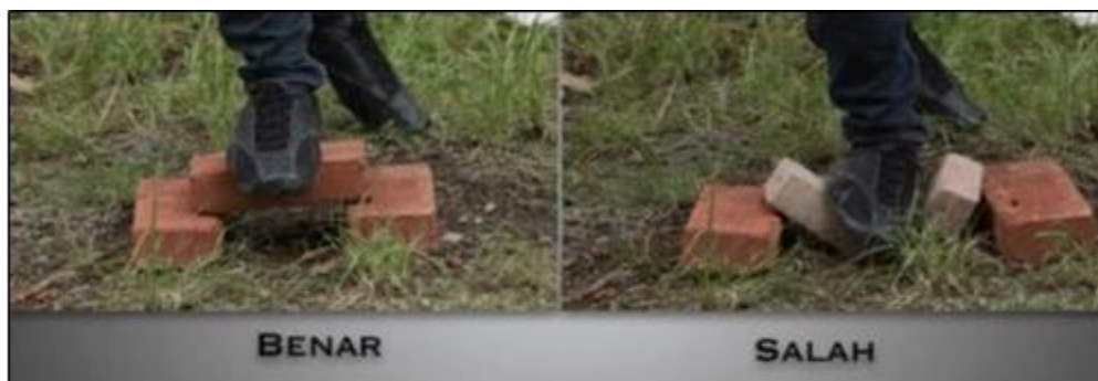
Gambar 13. Pengujian Sederhana Kekuatan Batu Bata
