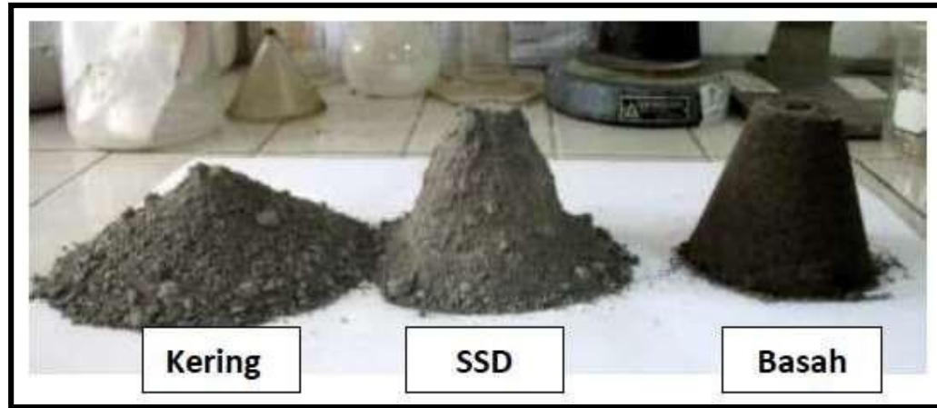
Gambar 1.6. Ragam Kondisi Agregat Halus
