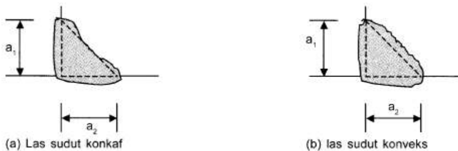
Gambar 7. 23 Gambar Ukuran Las Sudut.
