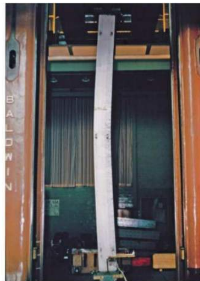
Gambar 4. 5 Gambar Kolom yang di bebani gaya Axial dan mengalami buckling .
