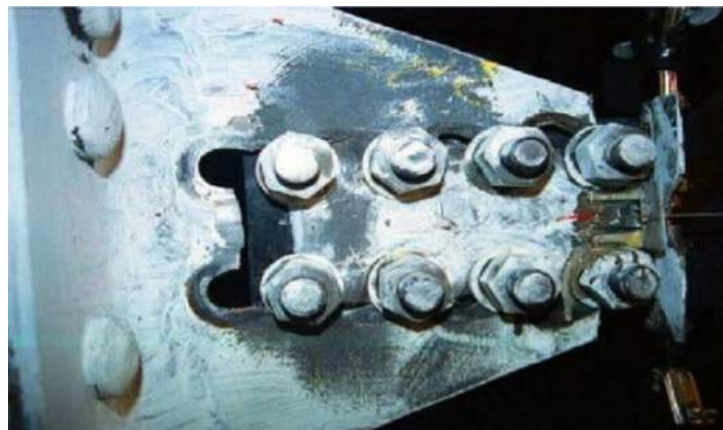
Gambar 4. 4 Keruntuhan geser blok, penampang tarik netto.
