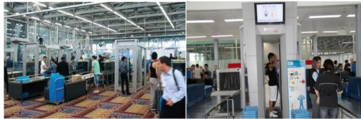
Gambar 5. Pemeriksaan Barang Penumpang menggunakan Peralatan X-Ray dan Walk Throuh Metal Detector pada Bandar Udara Suvarnabhumi (sumber : google.com)
