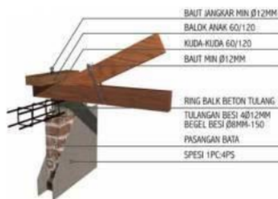
Gambar 8. Detil Atap dengan Pengaku
