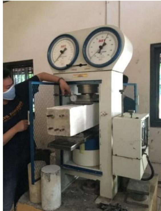
**Gambar 3. Pengujian Balok Beton Bertulang**
