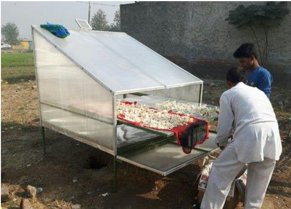
5.13. Pengeringan Buah-Buahan Dengan Energi Surya Secara Langsung
