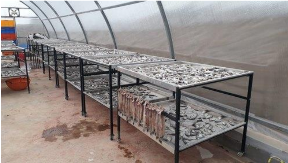
5.12. Pengeringan Ikan Dengan Energi Surya Secara Langsung
