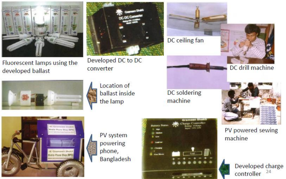
Gambar 3.1. Komponen pendukung PV serta pemanfaatan PV di daerah terpencil
