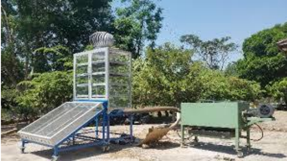
5.13. Pengeringan Buah-Buahan Dengan Energi Surya Secara Tidak Langsung
