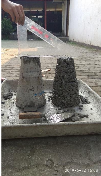
Gambar 8. Foto hasil uji slump beton berpori
