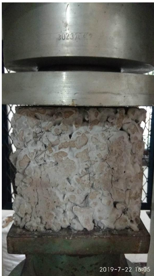
Gambar 7. Foto perbandingan retakan beton berpori dengan beton normal
