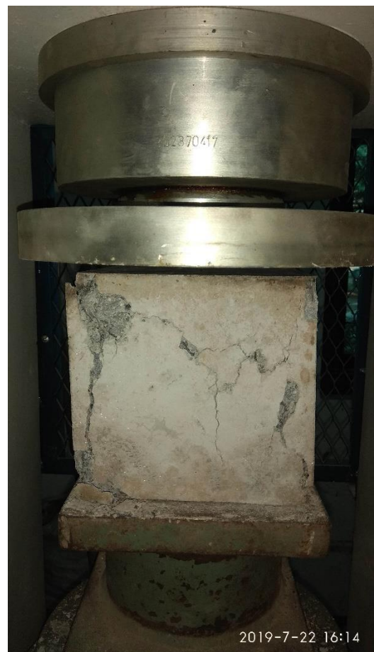
Gambar 7. Foto perbandingan retakan beton berpori dengan beton normal
