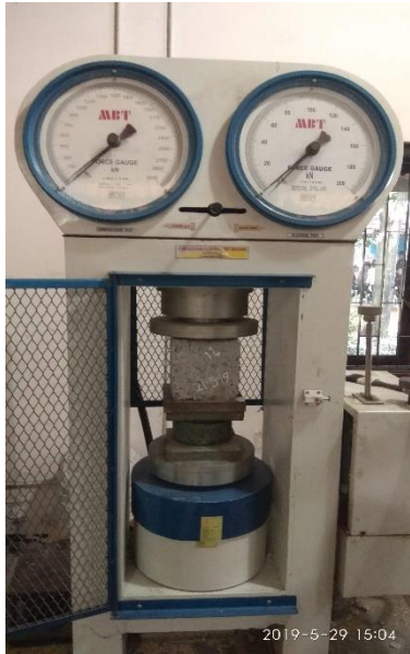
Gambar 15. Foto alat kuat tekan dan pengujian kuat tekan beton
