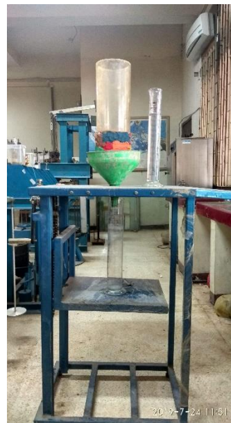
Gambar 16. Foto pengujian Permeabilitas beton berpori
