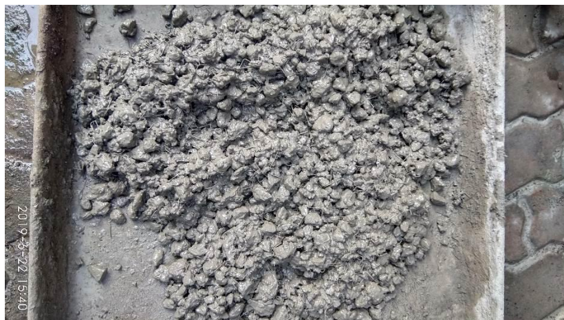
Gambar 5. Kondisi pencampuran beton berpori
