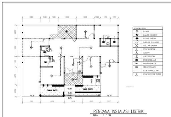
Gambar 5.14. Instalasi listrik (sumber: google image)
