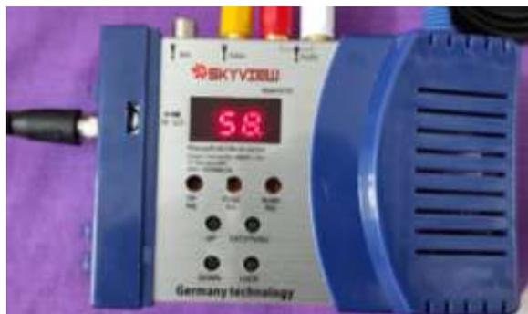
Gambar 2. Pengaturan Chanel pada Modulator AV to RF
