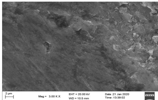
Gambar 4. Mikrograf dari paduan Al 6061, Penuaan buatan waktu 180 menit, temperatur 200 °C, pembesaran 3000X
