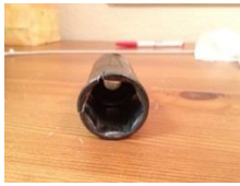
Gambar 22 Kondisi soket yang patah ( crack ) pada saat pemakaian
