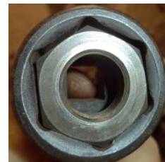
Gambar 12 Contoh penggunaan soket dengan desain flank drive
