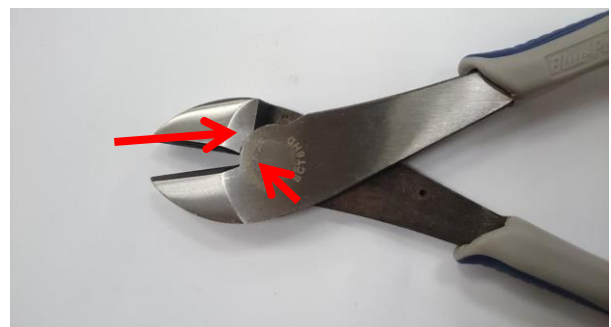
Gambar 24 Jarak poros dengan mata potong dan desain gagang/lengan
