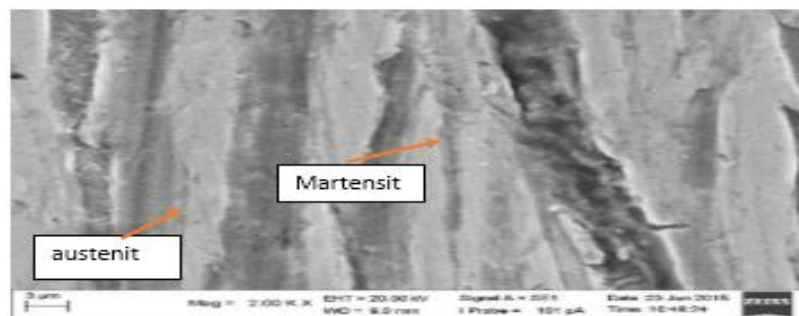
Gambar 7. Struktur Mikro Sampel yang Dipanaskan Pada Temperatur Heat Treatment 350^{\circ}\text{C} dan Didinginkan pada Media Pendingin Air dengan Perbesaran 2000 kali
