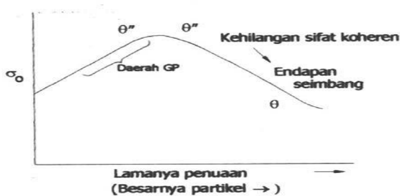
Gambar 2.1. Skema heat treatment T6 pada paduan aluminium
