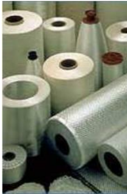
Gambar 5. 2. Ilustrasi reinforcement pada komposit
