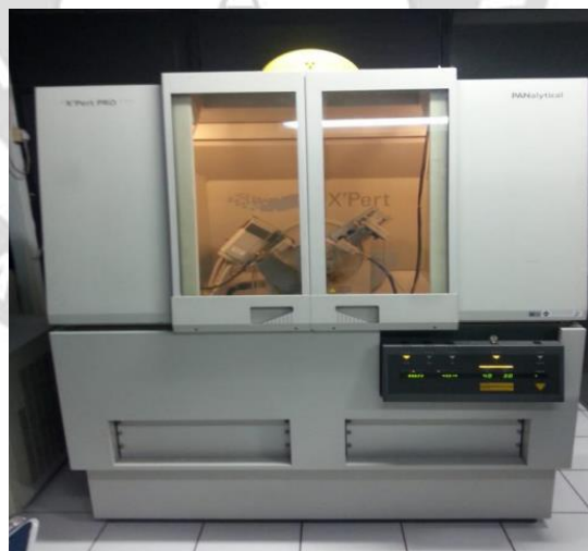
Gambar 3. 3 Alat XRD untuk uji kristal
