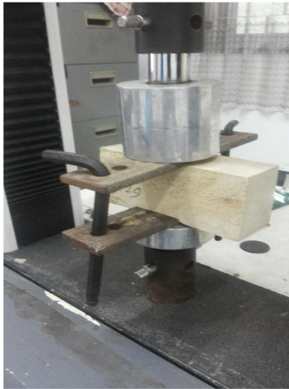
Gbr 7. Uji tekan pada kayu tanpa pemadatan.
