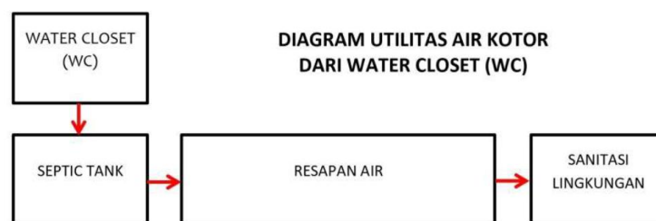
Gambar 4. Diagram Utilitas Air Kotor dari Water Closet (WC) (sumber: Pribadi)
