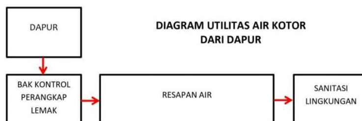
Gambar 6. Diagram Utilitas Air Kotor dari Dapur (sumber: Pribadi)
