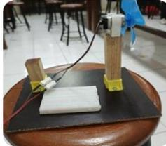
4. Pasang kabel generator ke breadboard sesuai kutub negatif dan positif pada generator, seperti pada gambar berikut.
