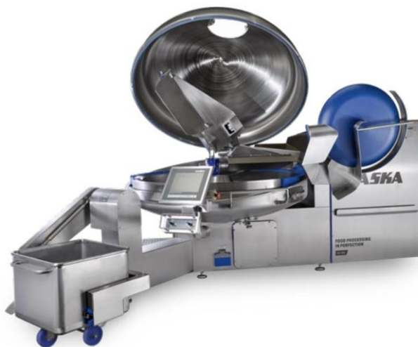
Gambar 2. 11 Mesin mangkuk pemotong LASKA KU500 (Sumber: (LASKA, n.d. ))
