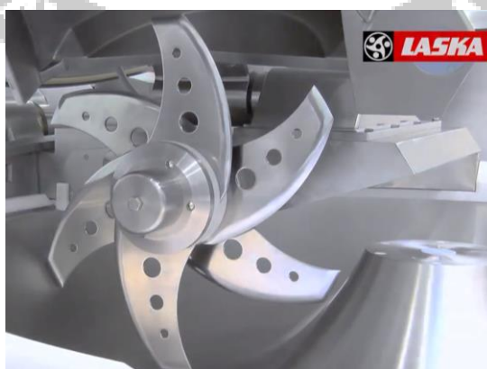
Gambar 2. 12 Pemasangan satu set pisau di mesin mangkuk pemotong (Sumber: (LASKA, n.d.))
