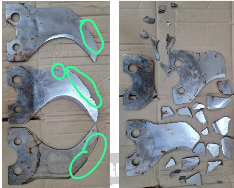
Gambar 2. 2 Kerusakan pada pisau setelah dilepas dari mesin mangkuk pemotong
