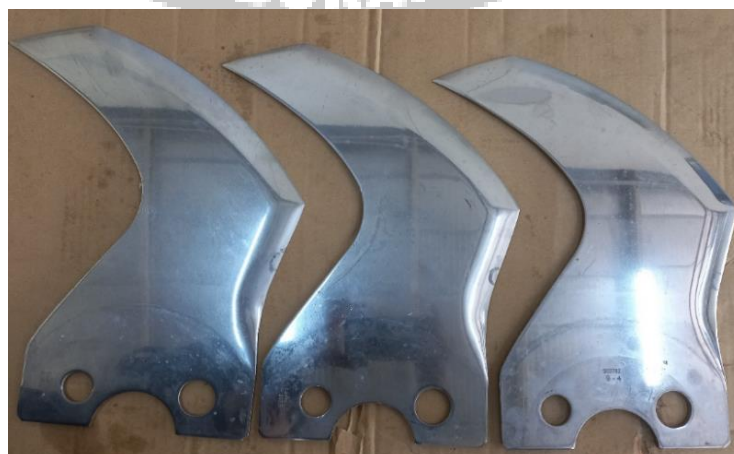
Gambar 2. 3 Keretakan pada pisau KU500 (Sumber: Diambil oleh penulis)
