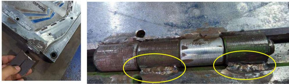
Gambar 1.1 Engsel dan holder patah/retak pada cetakan PVC
