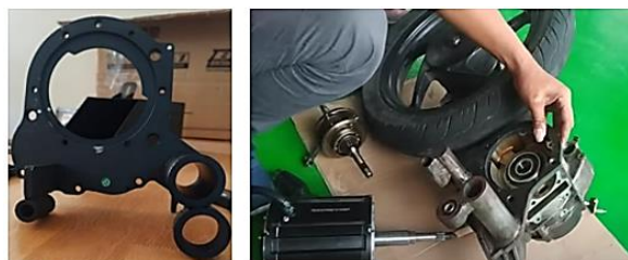
Gambar 3. Proses pemasangan, braket BLCD (kiri), pemasangan braket BLCD (kanan)
