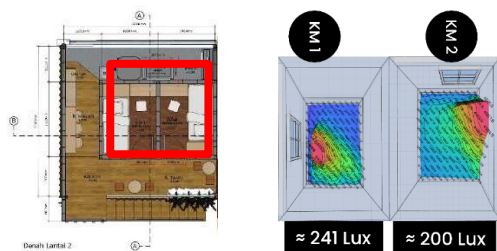
Gambar 22. Keyplan Denah Lantai 2 (kiri), Natural Lighting Comfort Analysis (kanan)
