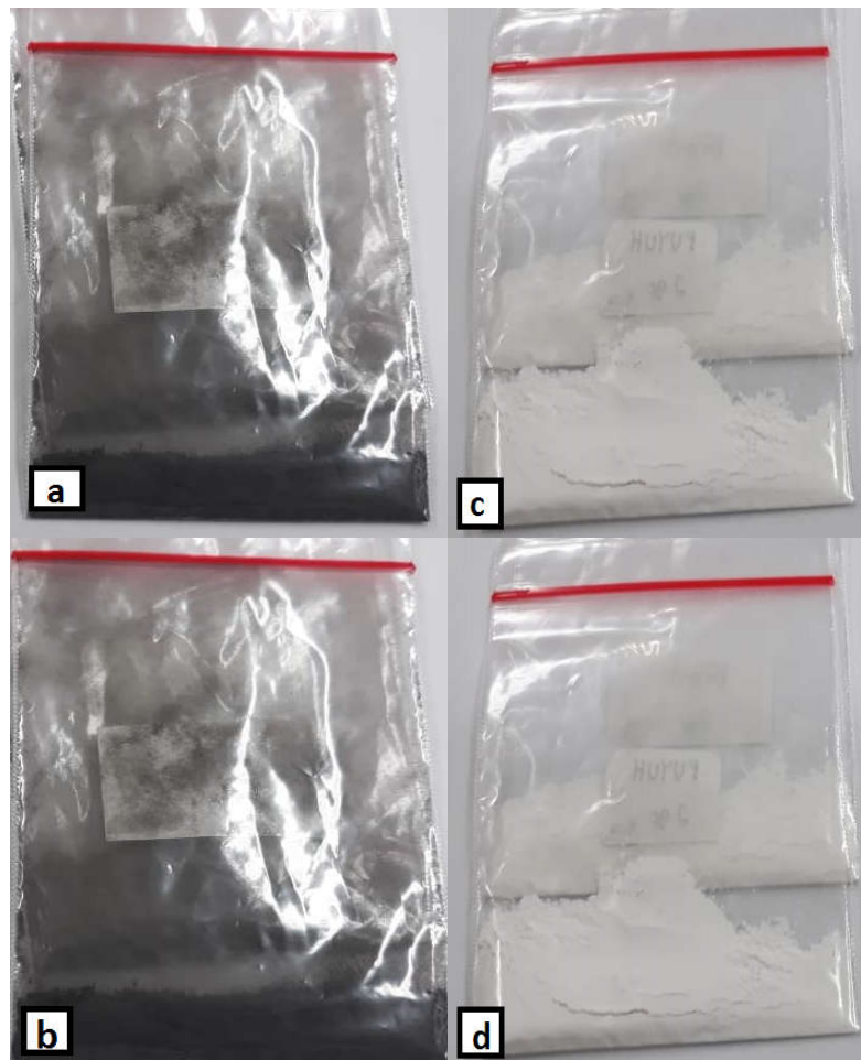
Gambar 2. Serbuk hasil kalsinasi selama 6 jam. (a). Cangkang bebek pada suhu 700 °C (b). Cangkang burung puyuh pada suhu 700 °C (c). Cangkang bebek pada suhu 1000 °C (d). Cangkang burung puyuh pada suhu 1000 °C.
