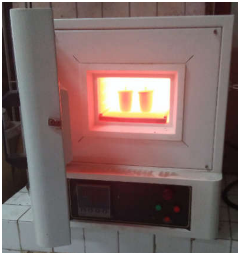
Gambar 1. Proses kalsinasi selama 6 jam.
