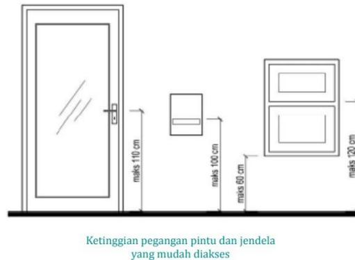
**Gambar 3.** Standar Pemasangan Pegangan Pintu
