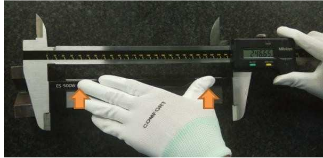
Gambar 7. proses penekan untuk mengeliminasi bending atau lendutan
