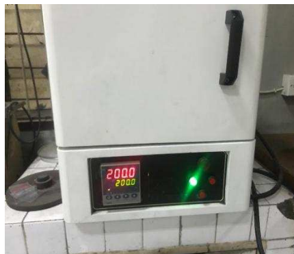
Gambar 8. Proses penuaan buatan pada suhu 200 °C
