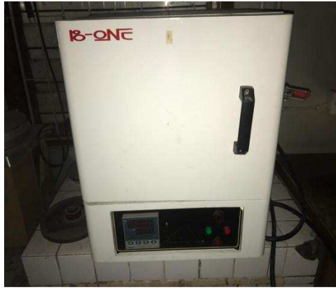
Gambar 2. Alat furnace dengan suhu maksimum 11000C (B-One)
