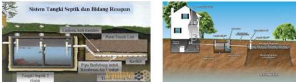
Gambar 122 : Foto septic tank dan bio tank (Sumber dokumentasi penulis)
