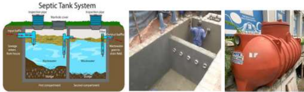
SEPTIC TANK TERBUAT DARI DINDING COR BETON DAN DINDING FIBER GLASS
