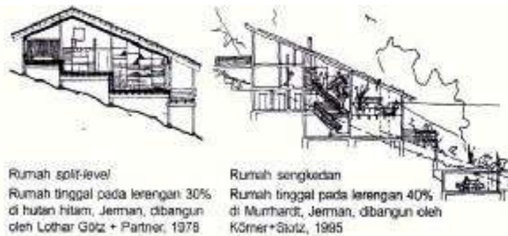
Gambar 61 : Sketsa pondasi pada tanah miring ( sumber sketsa penulis)
