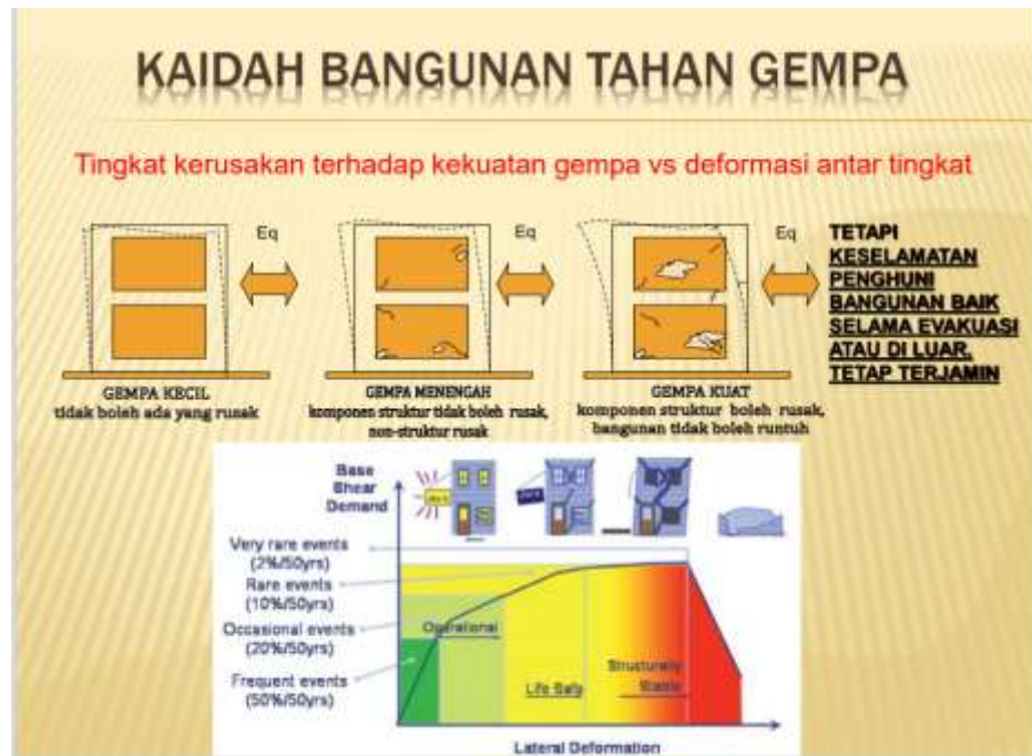
Gambar 32 : Sketsa Kaidah bangunan tahan gempa (Sumber Puslitbangkim PUPR)
