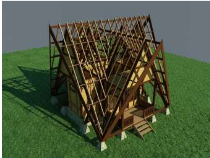
Gambar 27 : Foto kayu dipakai bahan struktur utama bangunan Mulai dari bawah (tumpuan dari pondasi umpak, sampai ke struktur atap (sumber dokumentasi penulis)
