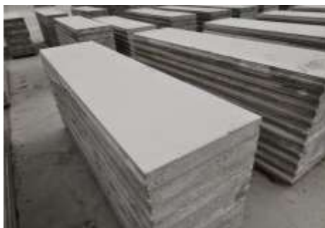
Gambar 50: Foto dinding beton precast (prefabrikasi). (Sumber dokumentasi penulis)
