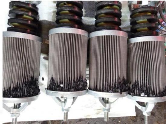
Gambar 1. 4 Serpihan *carbon paper disc* pada screen transmisi
