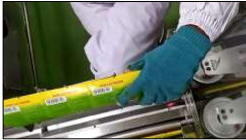
Gambar 1.1 Operator Memasukan Stripan dalam Feeding Mesin Manual
